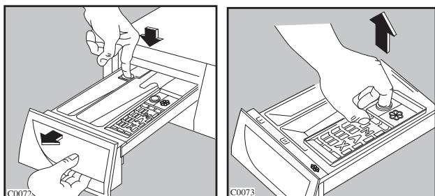
Стиральный порошок может также скапливаться в отсеке, в котором устанавливается дозатор: прочищайте его с помощью старой зубной щетки. После чистки установите дозатор на место.
