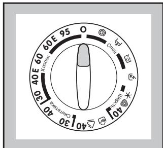
Селектор можно поворачивать как по часовой стрелке, так и против часовой стрелки.
